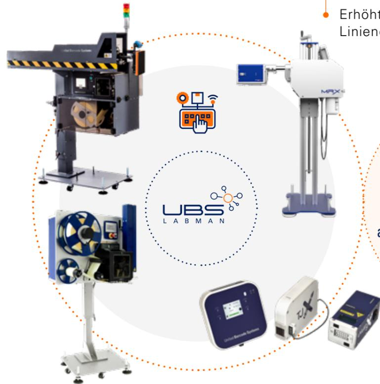
Kennzeichnung auf Verpackungen, Etikettierung von Sekundärverpackungen, Codierung und Direktdruck auf Kartons und Etikettierung von Paletten am Ende der Produktionslinie.
